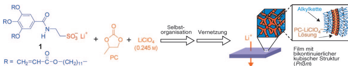
Abbildung 2. Herstellung von nanostrukturierten Filmen mit 3D-Ionentransportnetzen. [9]
